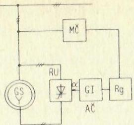
Obr. 248. Princip riadenia napäcia riadeným usmerňovačom
